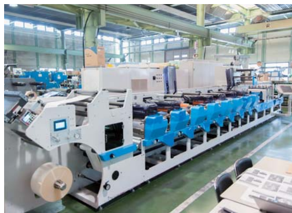
フレキソ印刷機 オペレーションするのがやさしく、水溶性インクを使用するため環境にもオペレーターにも負荷が少ない。
