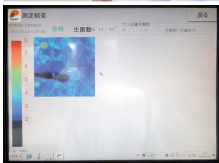
生菌可視化装置は原料を入れるだけでモニターに約1分で表示される。
