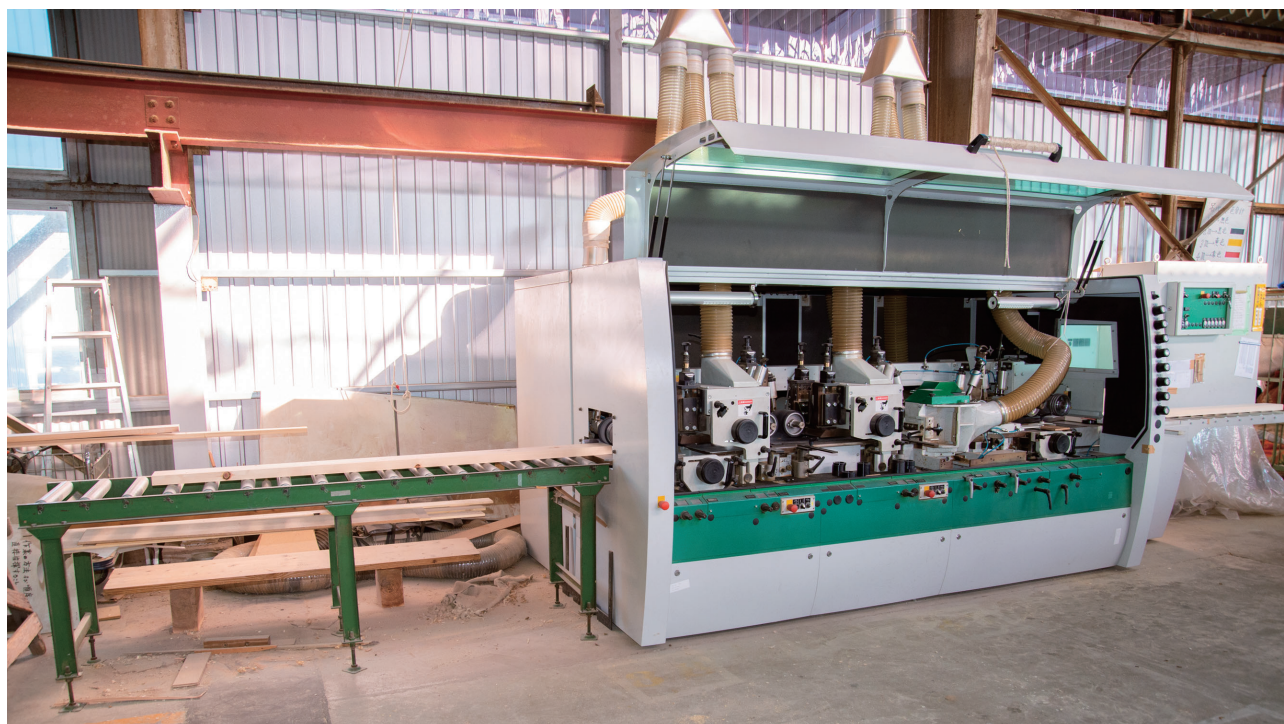
木材の四面を同時に切削できる新型多軸木工加工機
