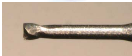
ボールエンドミルの先端拡大写真
