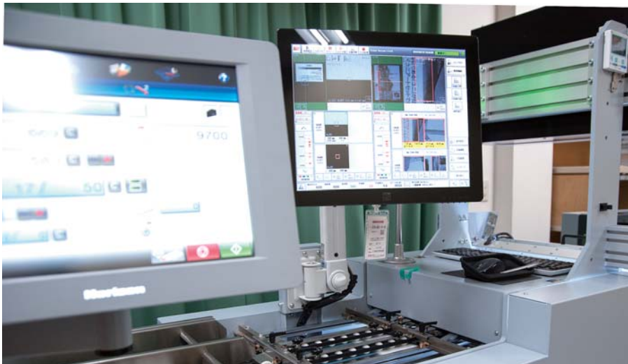
不良と判断された製品はどこに不備があったのかモニターで確認。 人間の目では確認できないほど小さな不良もはじかれる。
