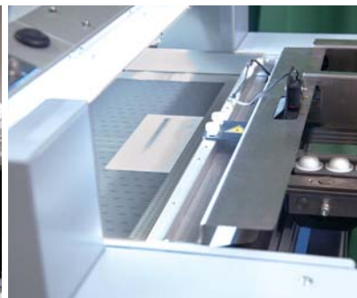
給紙部の後のコンベアに検知カメラを上下に搭載してある。
