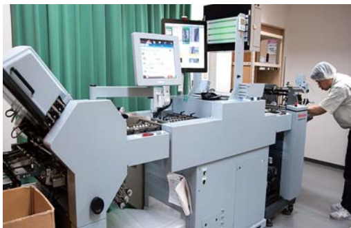
検知カメラ搭載の新型折機。
