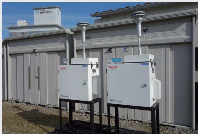
▲微小粒子状物質(PM2.5)のサンプラー。 基本は1か所に2～3台1組で設置しサンプリングする。
