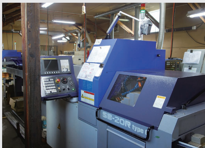
▲CNC自動旋盤。独自のチャック技術の応用により高精度を実現
