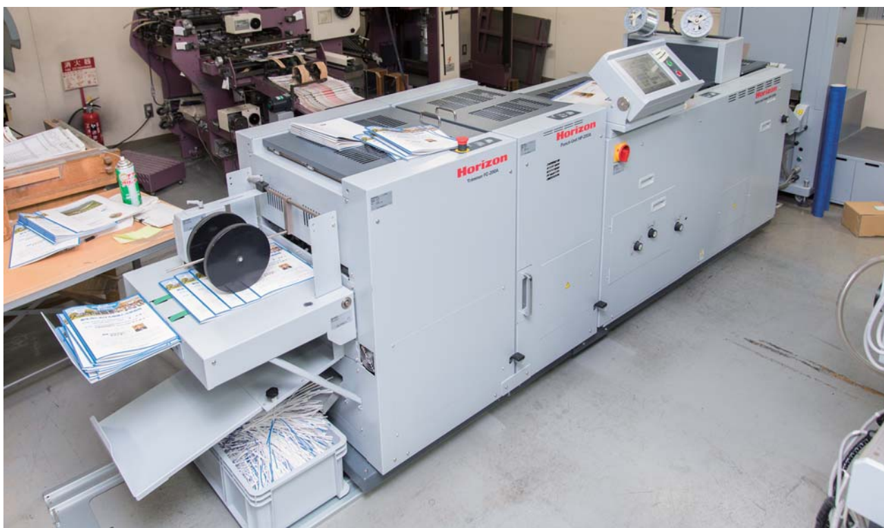
折加工機 外注していた細かい折加工が内製化で可能に。
