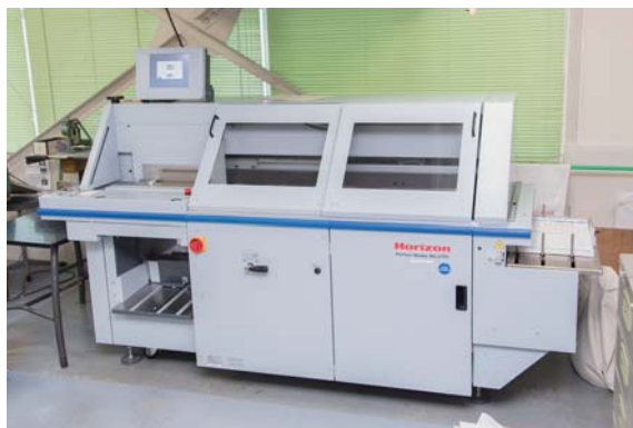
製本背貼機 コピーもしくは、簡易印刷したものを製本、背貼りして見栄え良くする。
