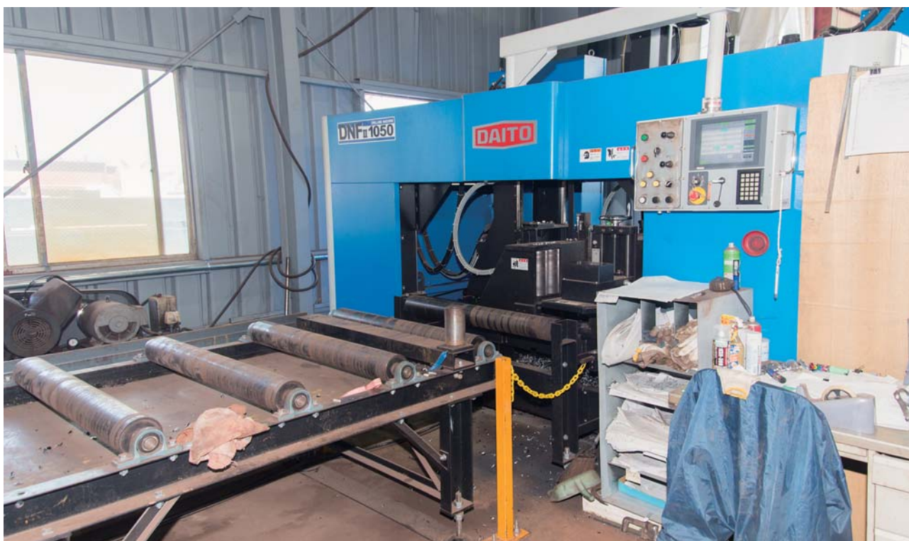
CADデータとの連携が可能なNCドリルマシンおよびバンドソーを導入。転記ミス等のヒューマンエラーも極小化された。
