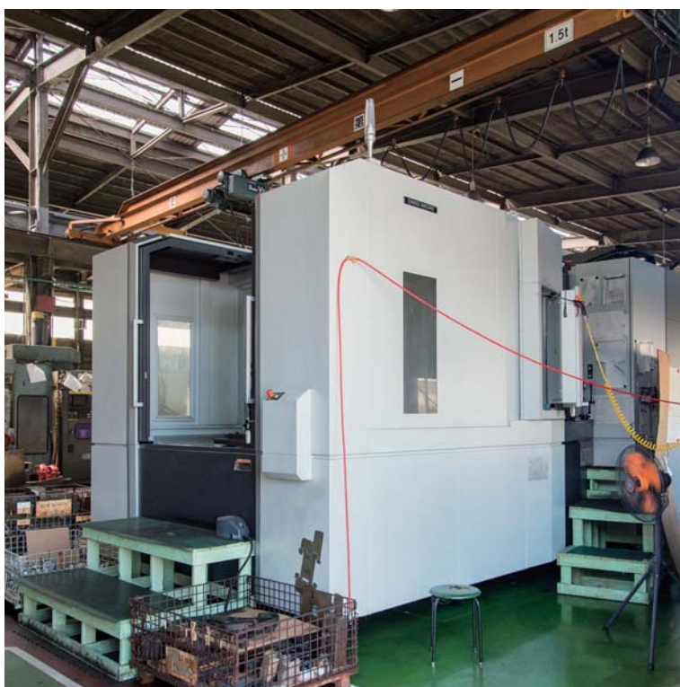
新規導入のマシニングセンタ。テーブルが大きいので、これまで対応できなかった大きい製品の加工が可能になった。
