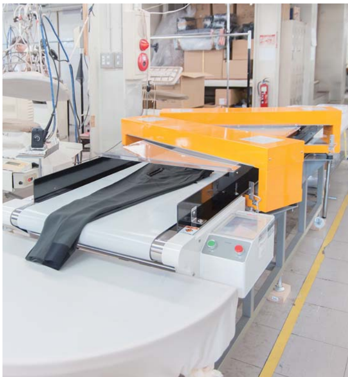
コンベア式ダブルヘッド検針機 2回の検針が1回で済む。
