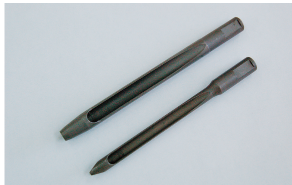
内径5ミリ（写真上）、4ミリ（下）の極細タイン
