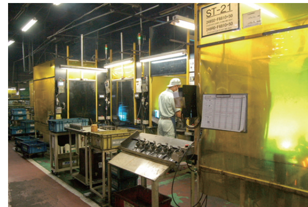
動線などを考慮し、コの字に並んだ4台の機械を1人で管理している
