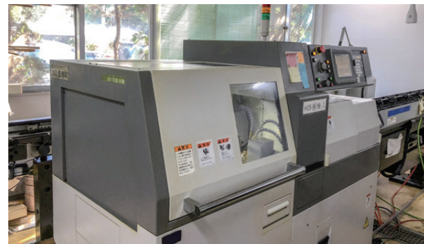
開発した機械では、NC旋盤内で全工程をワンチャックで加工でき、不良率はゼロ。全くぶれもなく、非常に精巧な製品が仕上がる
