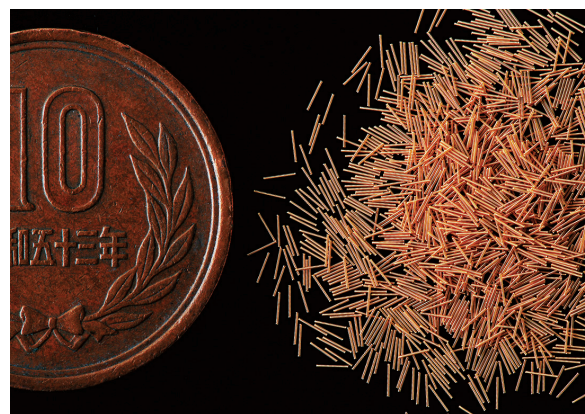
線径20マイクロメートルの微細なスプリングへのめっきも可能
