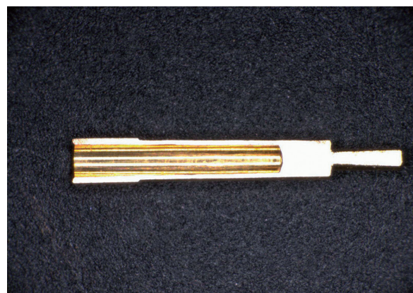
袋穴へのめっき。複雑な形状へ、均一の膜厚でのめっきが求められる
