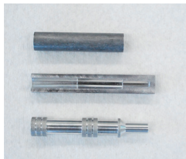
バルブソレノイド。T6熱処理した素材（写真左）を用い、冷間鍛造で製造
