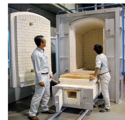
笠間陶芸大学校に納入された大型のオブジェ用ガス窯。窯内温度差がゼロを実現
