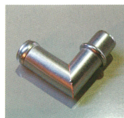
▲ろう付け炉に入れて完成した製品
