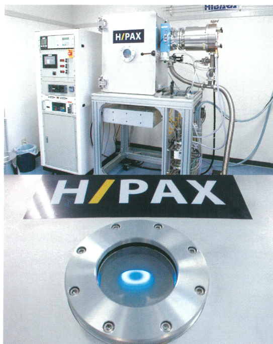
◀DLCプラズマ蒸着装置。「H/PAX」はオリジナルの登録商標である
