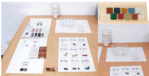
▲DLCコーティングサンプル。厚み11ミクロンのアルミホイルに200ナノメートルのDLC膜を蒸着させることで、5気圧でも酸素不透過が可能となるという。DLCでは、0.2ミクロンという薄さの高機能の膜も実現している
