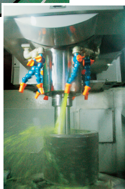
新規導入した立型複合研削盤。プログラム制御で、立位のまま、円柱の内側と外側を切削することができる
