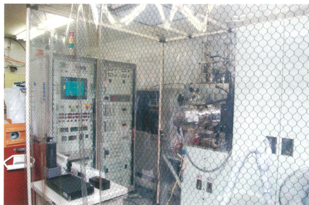
▲DLCコーティング設備及びクリーンブース
