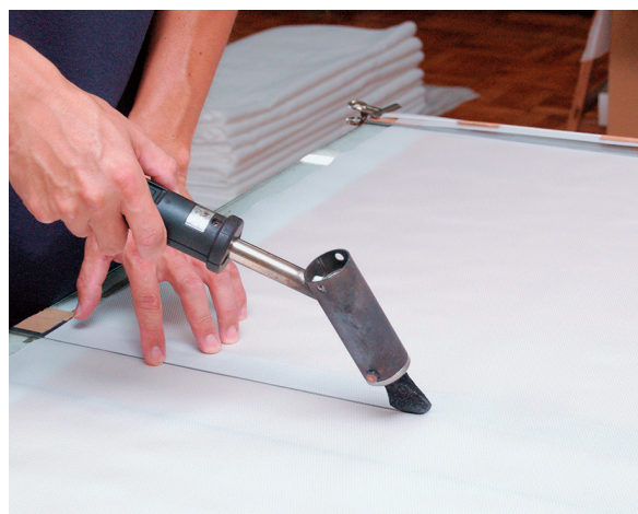
電気コテで布を裁断する。コテを熱するには30分かかる
