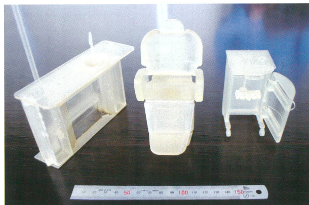
▲設計図を元に、3Dプリンタで製作したミニチュアモデル
