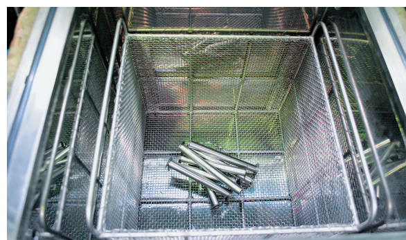
バスケットの中に洗浄したい部品を入れる。バスケットの大きさは300×300×H250（ミリ）
