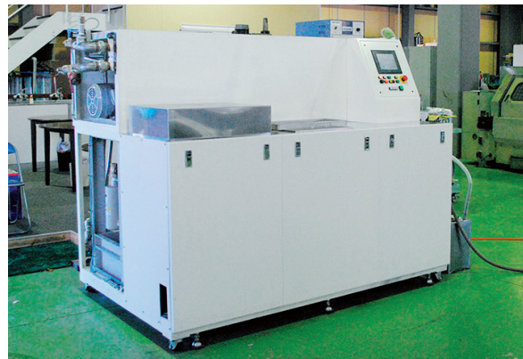
「炭化水素系 1 槽式真空洗浄機」。①真空超音波洗浄（粗洗浄）②真空超音波洗浄（仕上洗浄）③真空ペーパー洗浄④真空乾燥。この4工程を1槽の中で行う
