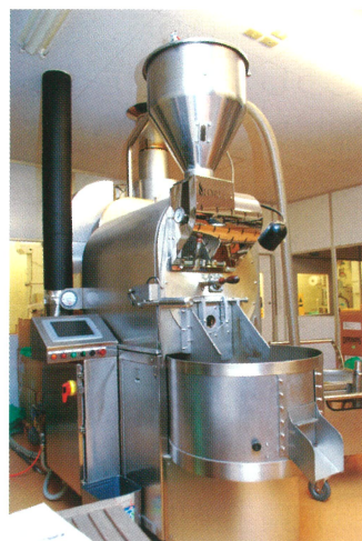
▲新たに導入したアメリカ製焙煎機「ローリング（スマートロースターKestrel S35）」
