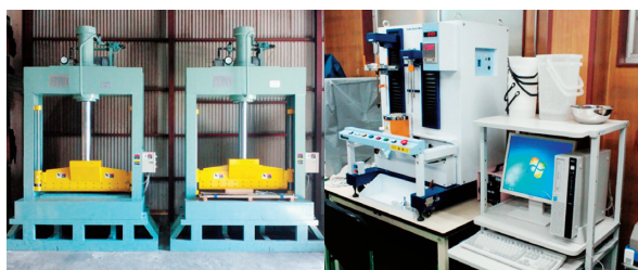
切断機で素材の同時切断が可能になった（左）。メルトインデクサーでは生成された混合ペレットのMFR値測定を行う（右）
