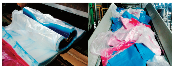
ロールを切断して、押出機に投入し、一次加工を行う
