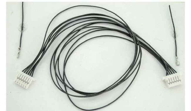
医療用モバイル型ファイバースコープシステムで使われている細物電線を使ったワイヤーハーネス
