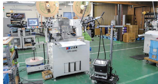
全自動両端端子圧着機の脇にハイスピードマイクロスコープを設置し、動画で確認をする
