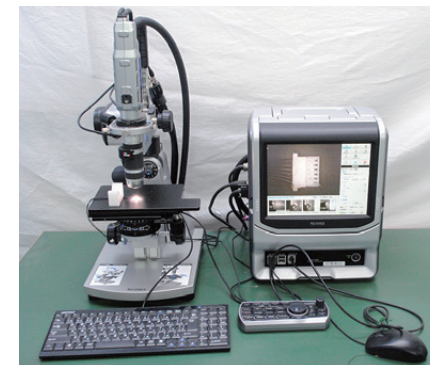
マイクロスコープを顕微鏡として利用することで、圧着部分を画像で確認できる
