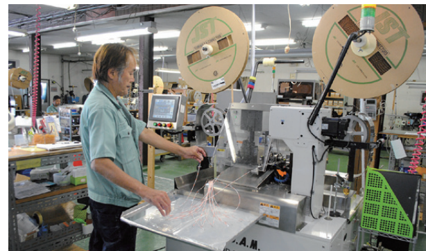
AWG30・32に対応する圧着機。品質は安定し、顧客の信頼度もアップした
