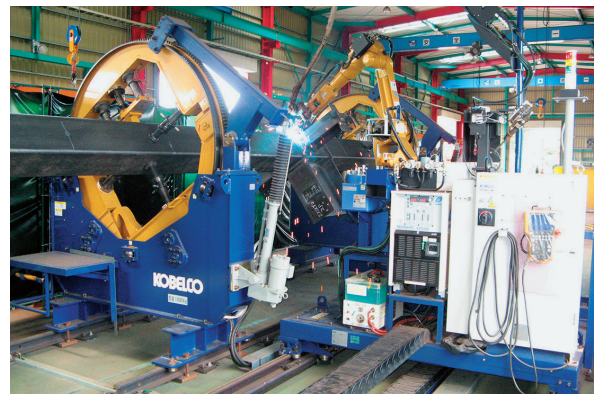
アームを伸ばして溶接を行う溶接ロボット。パソコンで設定を終えれば、人間は現場から離れることができる
