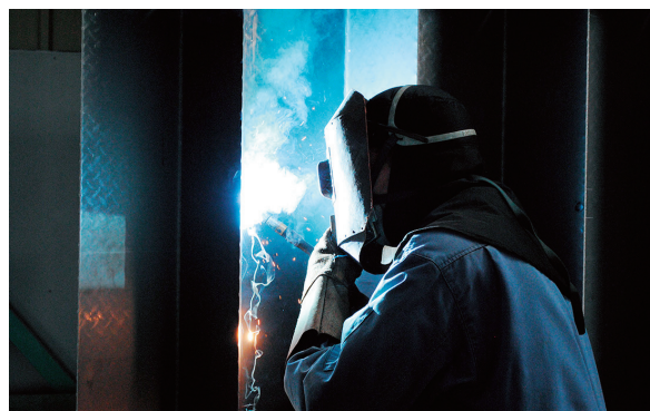
煙のように見えるのは、鉄粉やリンなどの金属による細かい粒子である溶接ヒューム。人体に悪影響を与える溶接ヒュームから作業員を守るのも、溶接ロボットの大きな特徴だ
