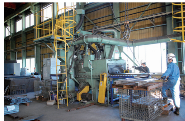
ショットブラストマシン。穴開き加工を施した後の鋼板の表面を加工する
