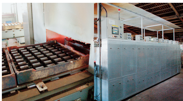
新たに開発・導入したローラーハース式新電気炉
