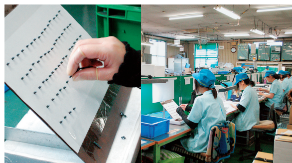
磁気を入れた後、精密な検査を経て製品となる
