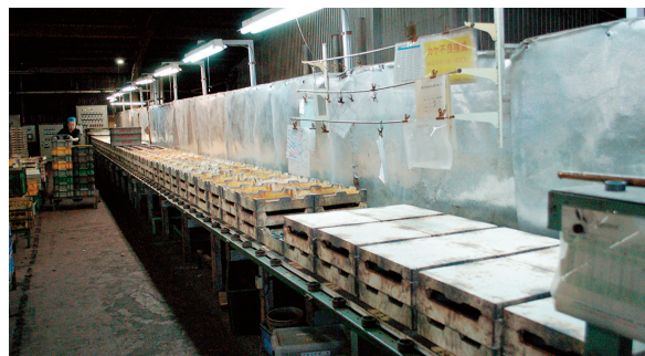
従来の大型プッシャー式連続炉。大量生産に対応したものだっ
