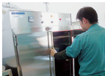
スプレードライヤでの磁粉造粒後の粒子中の揮発成分の乾燥と、粉碎法での乾燥機として使用するために送風定温乾燥機を導入
