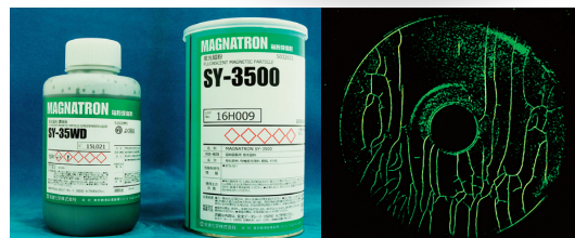
磁粉探傷剤の蛍光磁粉。鉄鋼材の表層部傷の探傷に最適だ
