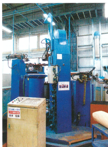
▲各工程の機械を1カ所に集約した従来の機械。新しい装置はこのユニット2つ分の生産量がある
