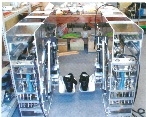
◀ カム機構を使った試作機
