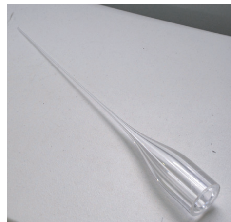
母材から引き取った状態
