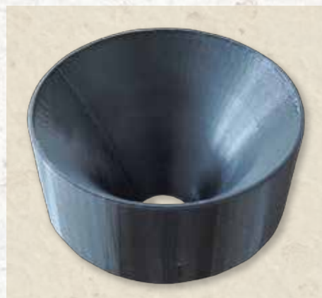
3Dプリンターで作成したセンサ部のホーン
