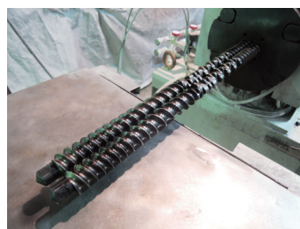
二軸混練押出機に設置された2本のスクリー
