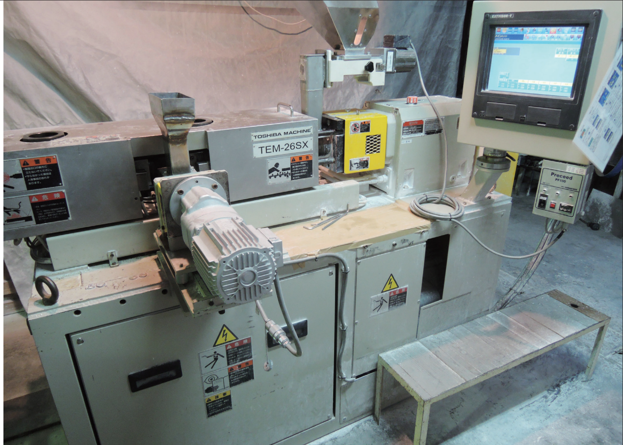
高濃度に機能材を練り込むためのサイドフィーダー付二軸混練押出機
