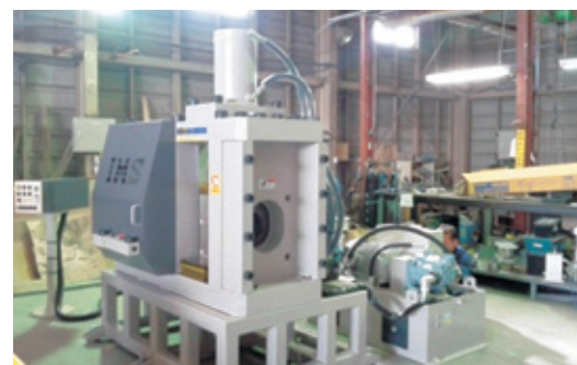
機械装置(油圧プレス式パイプ端末成形機)の導入据付
