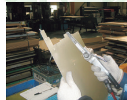
バリ取り機導入前のバリ取り作業
