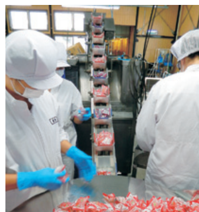
こんにゃくゼリー外装機へ一定数の個装を計測し投入する現状
