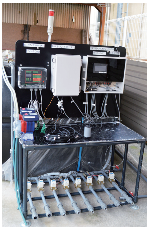
各種コントローラーの背後にあるタンクから下部のチューブを通してかん水が行われる
