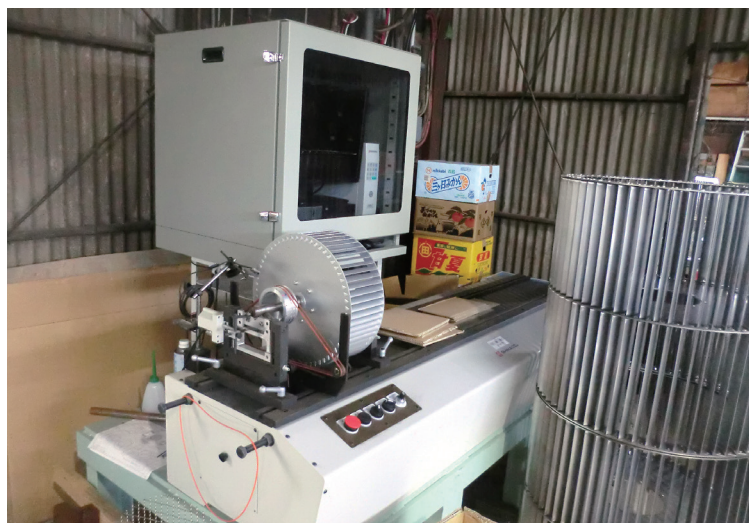
島津製作所製のバランス修正機。最大直径1.5メートルまで対応可能
