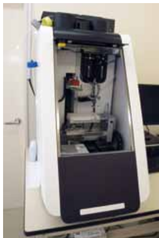
最新鋭のオートパッチクランプ装置「サイトパッチ4」
