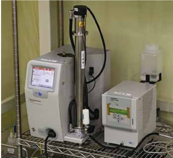
ナノレベルのごみの数を測定できるパーティクルカウンター
