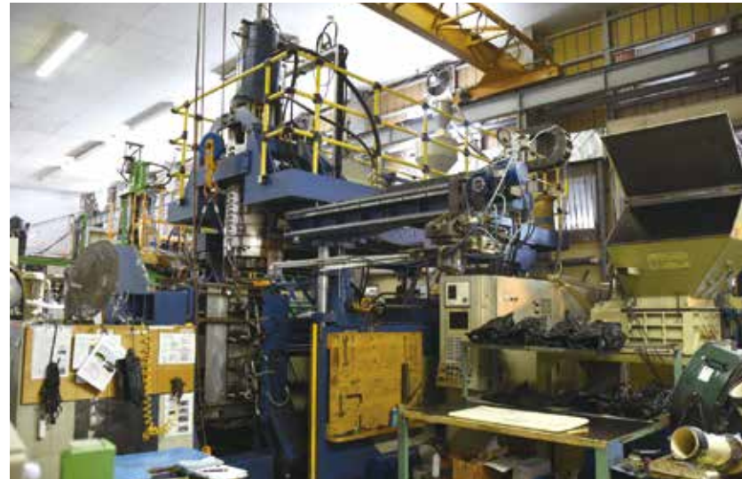
一度に10キロのパリソンを押し出すことができる大型のブロー成形機
