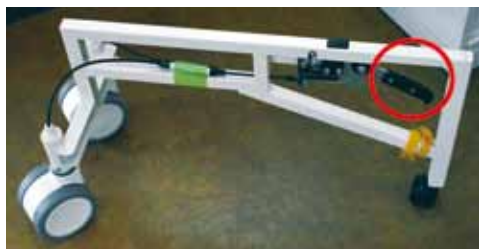
新しい機構を組み込んだ2輪のキャスターの模型。○で囲ったレバーを操作することで、同時にロックをかけたり外したりできる
