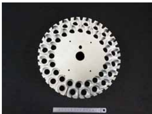
5軸加工のマシニングセンターで加工した医療機器用部品
