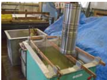
手前が汚れを落とすタンク。上に乗っているのがめっき前のシンダーライナー
