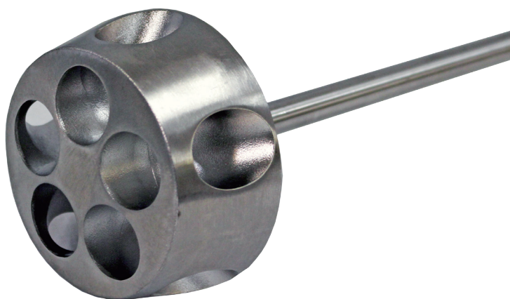
C-Mix。底の穴から吸い上げられた液体が側面の穴から吐き出され、容器内で竜巻状の水流を発生させる
