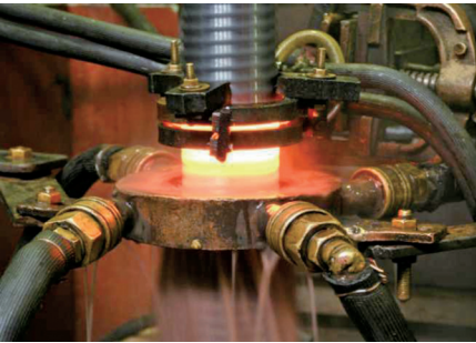
高周波焼入れ工法
