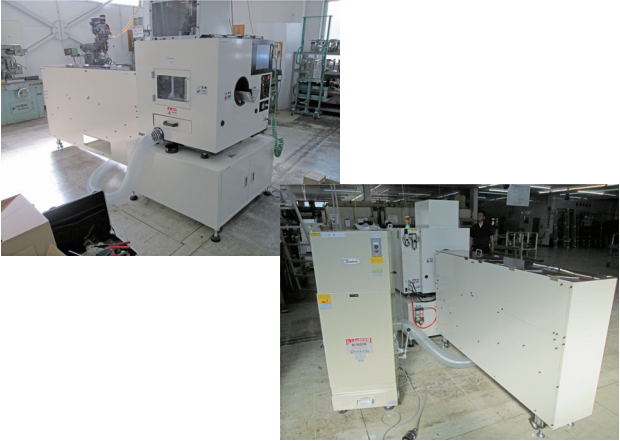
導入した「アルミサッシ加工機 (Sash-IN)」
